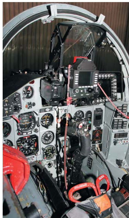
Справа вверху: кабина модернизированного словацкого МиГ-29: хорошо заметны новый многофункциональный индикатор МФИ-54 на месте привычного ИПВ и пульт управления ПУС-29, установленный под ИЛС
