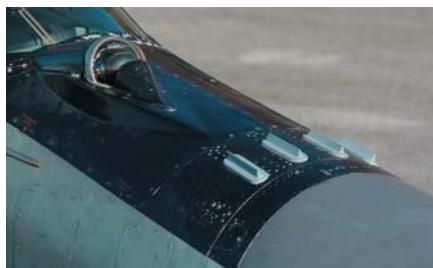
Внизу: новые антенные системы – внешние отличия модернизированных по стандартам НАТО и ИКАО истребителей МиГ-29 ВВС Словакии
