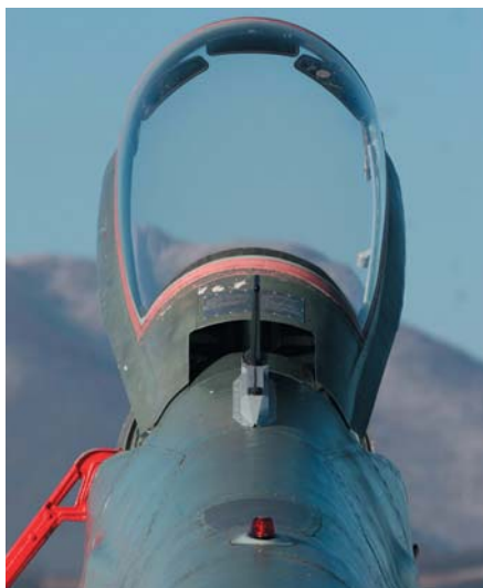
Внизу: новые антенные системы – внешние отличия модернизированных по стандартам НАТО и ИКАО истребителей МиГ-29 ВВС Словакии
